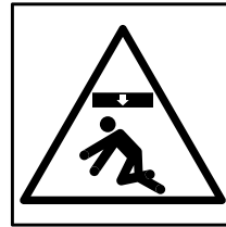
Klämfara - fallande material
