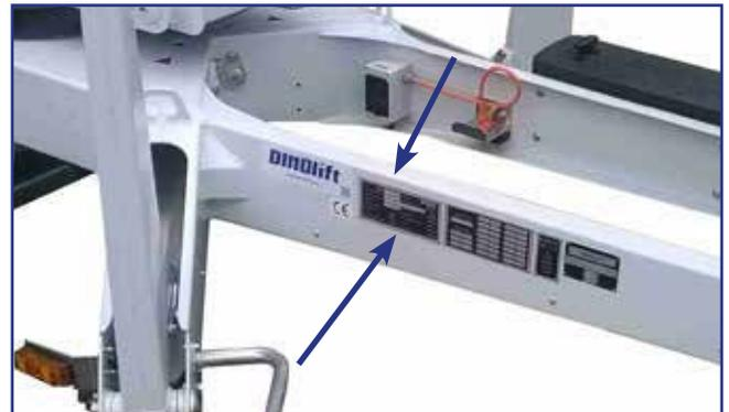
Das Schild für die Typinformationen des Trailers befindet sich auf der rechten Seite des Typenschildes an der im Bild markierten Stelle.
