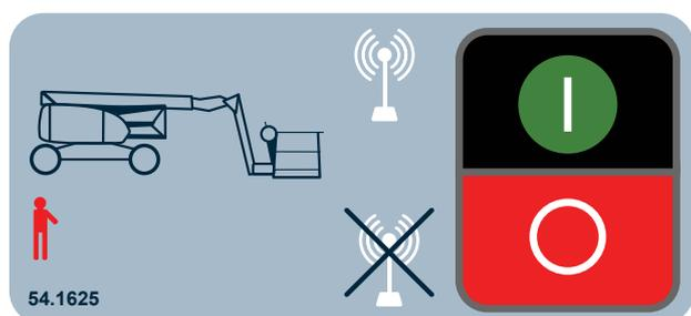
Wenn die Maschine mit einer Funkfernsteuerung ausgestattet ist, befindet sich der RCTX-Aktivierungsschalter S48 anstelle des Schalters S47 an der LCB-Steuerungseinheit.
