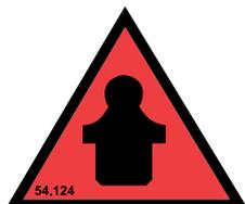
Die Schmiernippel in der Maschine sind mit diesem Schild gekennzeichnet, sofern sie sich nicht an einer gut sichtbaren Stelle befinden.
