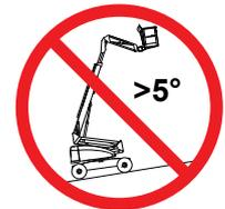
Sicherstellen, dass die Hubarbeitsbühne an einem Hang nicht abgleiten kann.
