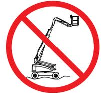
Bei angehobenem Arbeitskorb darf der Schrägstand 5° nicht überschreiten. Eine Warnleuchte am Arbeitskorb weist darauf hin, wenn der Schrägstand zu groß ist.
