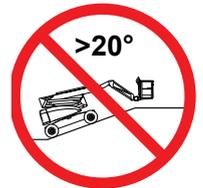
Darauf achten, dass der Arbeitskorb nicht auf dem Boden aufschlägt. Beim Fahren auf unebenem Untergrund die Korbarme etwas anheben.
