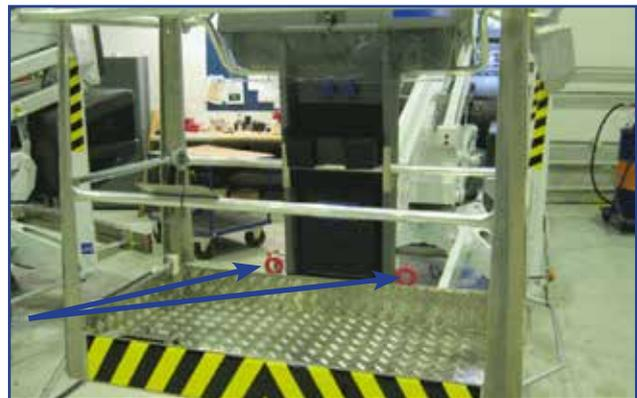
Die Hubarbeitsbühne darf nicht für den Transport von Gegenständen oder Personen zwischen verschiedenen Stockwerken oder Plattformen eingesetzt werden. Das Betreten oder Verlassen einer in Bewegung befindlichen Arbeitsplattform ist verboten.
