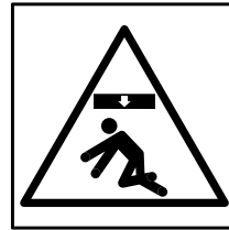
Einklemmgefahr - fallendes Material
