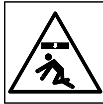
Einklemmgefahr - fallendes Material
