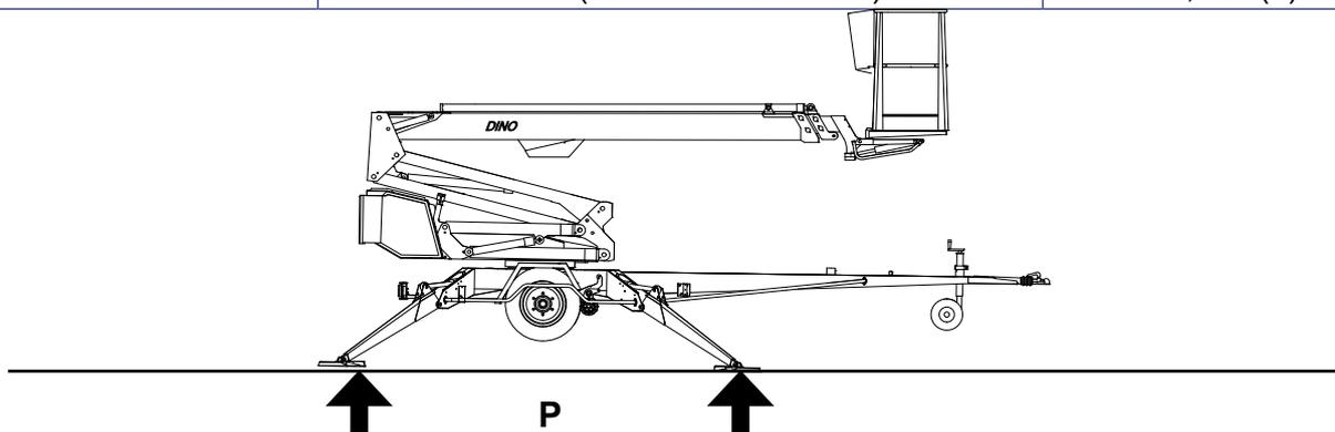
2. Stellen Sie sicher, dass sich auf der Arbeitsunterlage keine Vertiefungen, Löcher oder zu stark geneigte Stellen befinden.
