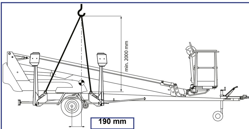
Beim Heben der Personenhebebühne muss sie sich in Transportstellung befinden. Entfernen Sie vor dem Heben alle losen Teile auf dem Rahmen und dem Korb. Verwenden Sie zum Heben ausreichend stabile Kräne und Hebehilfsmittel. Kontrollieren Sie in den technischen Daten das Gewicht der Hubarbeitsbühne.
