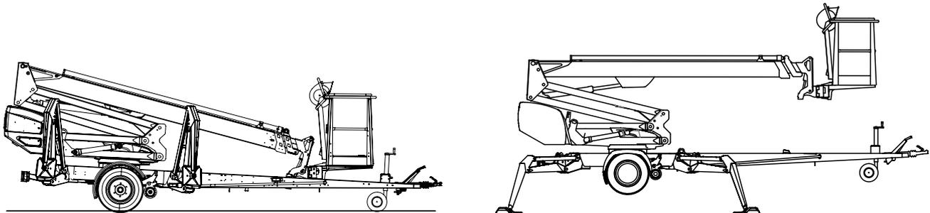
Die vorrangige Antriebsquelle der Hubarbeitsbühne ist Elektromotorantrieb. Die Bewegungen der Stützbeine und der Arme erfolgen hydraulisch.
