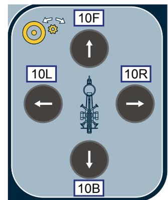
**Achtung!** Die Bewegungen der Arme und des Arbeitskorbs stoppen, wenn der Geschwindigkeitwahlschalter oder Wahlschalter der Bewegung gelöst wird.
