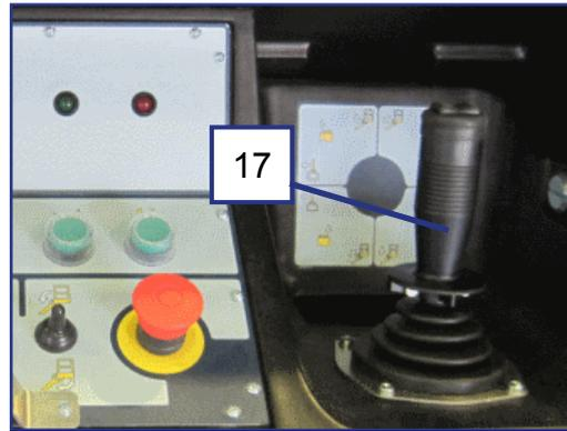
Die verschiedenen Funktionen werden mit den Kontakte auf dem Joystick gewählt. Drücken Sie immer erst die Taste und schwenken Sie den Griff erst danach. Der Sicherheitsschalter verhindert Bewegungen, wenn der Griff vor der Betätigung der Taste umgestellt wird.
