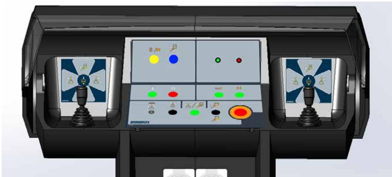
Der rechte und linke Joystick (17 rechts/links) ersetzen den normalen Joystick 17. Die verschiedenen Funktionen werden durch Kippen des Joysticks in die gewünschte Richtung gewählt. Drücken Sie immer zuerst die Taste auf dem Joystick und schwenken Sie den Griff erst danach. Der Sicherheitsschalter verhindert Bewegungen, wenn der Griff vor der Betätigung der Taste umgestellt wird.
