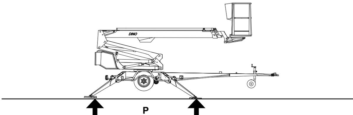
2. Stellen Sie sicher, dass sich auf der Arbeitsunterlage keine Vertiefungen, Löcher oder zu stark geneigte Stellen befinden.
