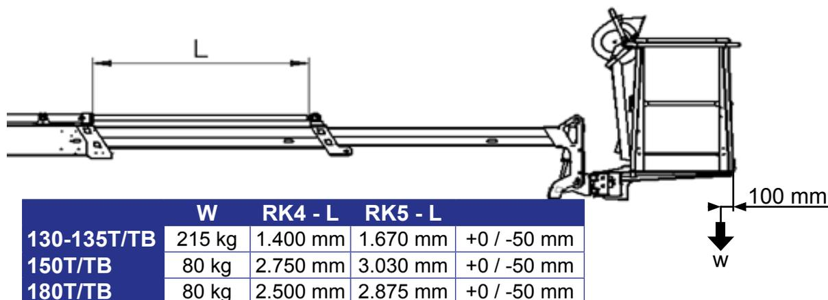
Die rote Lampe blinkt, wenn **RK4** die Bewegung unterbricht. Nach einer derartigen Unterbrechung sind Bewegungen nur in eine Richtung möglich, die innerhalb des Sicherheitsbereichs liegt.
