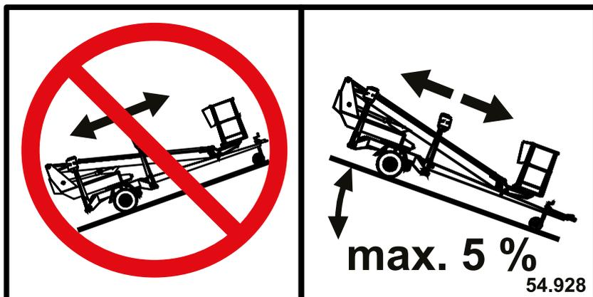
**Nicht mit dem Fahrtrieb bergabwärts fahren, wenn die Neigung größer als 5 % ist (0,5 m Neigung auf 10 m Strecke). Bei größerer Neigung könnte die Maschine außer Kontrolle geraten.**
