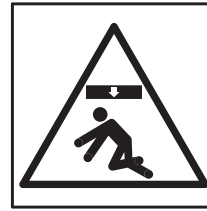
Klämfara - fallande material
