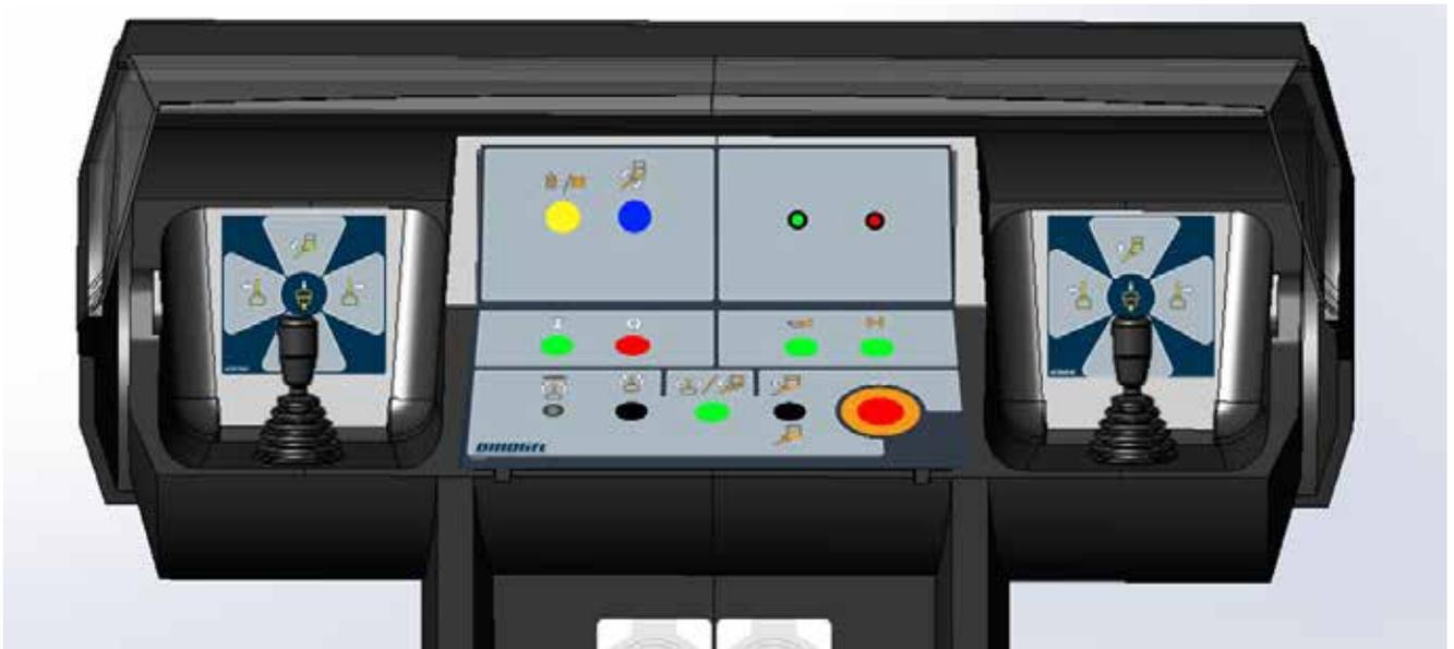
Der rechte und linke Joystick (JST rechts/links) ersetzen den normalen Bedienhebel.
