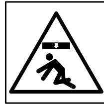
Einklemmgefahr - fallendes Material
